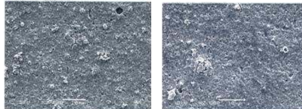
処理時間：10日間 処理時間：20日間 図 3-3 オゾン濃度：5mg/L, 浸せき後 SEM 画像 (2000 倍)
