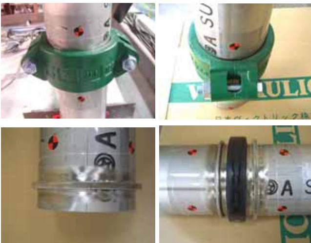
写真 - 7 回収したハウジング継手
