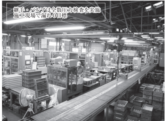
写真6 本社工場の圧力漏れ検査風景
