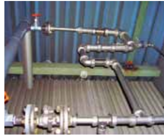
写真 180℃による実体試験 (寿命推定のための試験設備)
