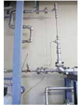
写真 180℃による実体試験 (寿命推定のための試験設備)
