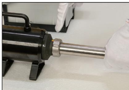
4. Inserite completamente il tubo nell'asta di guida.
