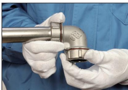
8. Posizionare la rondella conica nella parte in cui l'estremità del dado di serraggio entra in contatto con il raccordo, e serrare il dado fino a quando la superficie colorata non è più visibile.
