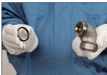
7. Qualora la guarnizione di tenuta in gomma dovesse cadere, assicurarsi di riposizionarla sul corpo principale del raccordo.
