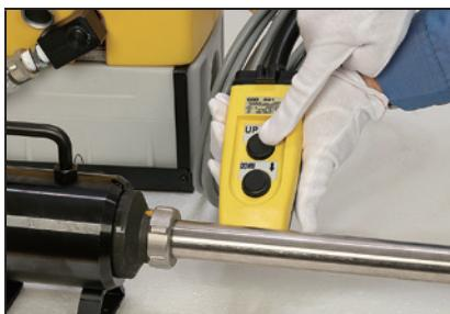
5. Para el trabajo de expansión de tuberías, mantener pulsado el botón «UP» hasta que el motor se detenga. A continuación, pulse el botón «DOWN» durante aproximadamente dos segundos para liberar la presión.
