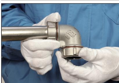
8. Coloque la arandela cónica en una sección en la que la superficie lateral de la tuerca entre en contacto con el accesorio, y apriete la tuerca hasta que la superficie coloreada no sea visible.
