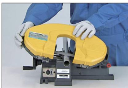
1. Tomando como referencia la tabla de dimensiones para el corte de tuberías, corte la tubería en ángulo recto con respecto al núcleo del eje con una sierra para metales o una sierra de cinta.
