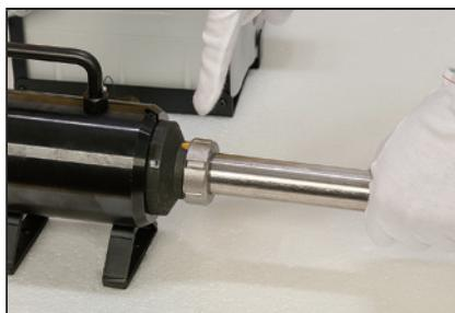
4. Inserte completamente la tubería en la varilla guía.
