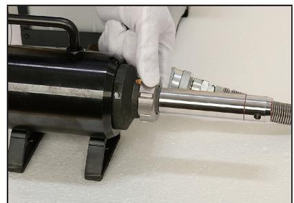
3.Ziehen Sie die Hutmutter am Bügel fest an.
