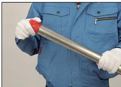
2.Entfernen Sie Grate mit einer Reibahle, Sandpapier und einer Schleifmaschine vorsichtig von den innen und außen abgefasten Oberflächen.
