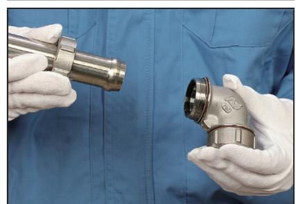
6.Stecken Sie das verlängerte Rohr in das Anschlussstück und ziehen Sie die Hutmutter fest an.
